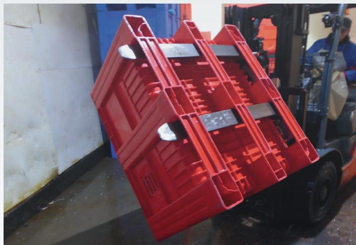
La conception évoluée de la CB3 avec ses parois extérieures renforcées grâce aux nervures supplémentaires augmente la résistance aux impacts des chocs causés par les dents des fourches des chariots élévateurs. De plus, sa fabrication en injection monobloc renforce également sa solidité et sa durabilité, offrant une charge maximale allant jusqu'à 1.200 kg.
