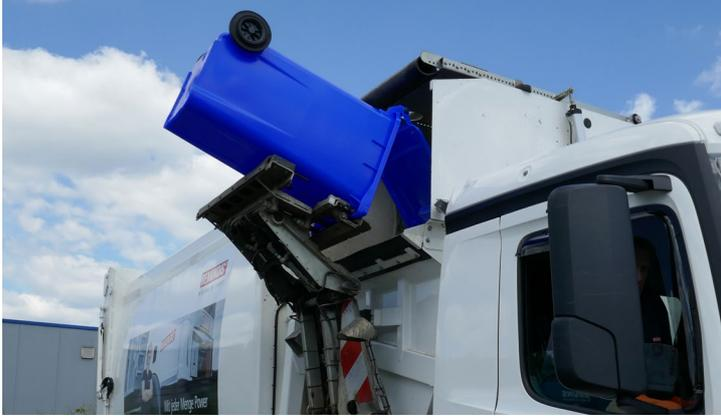
Prueba de elevación y vaciado
